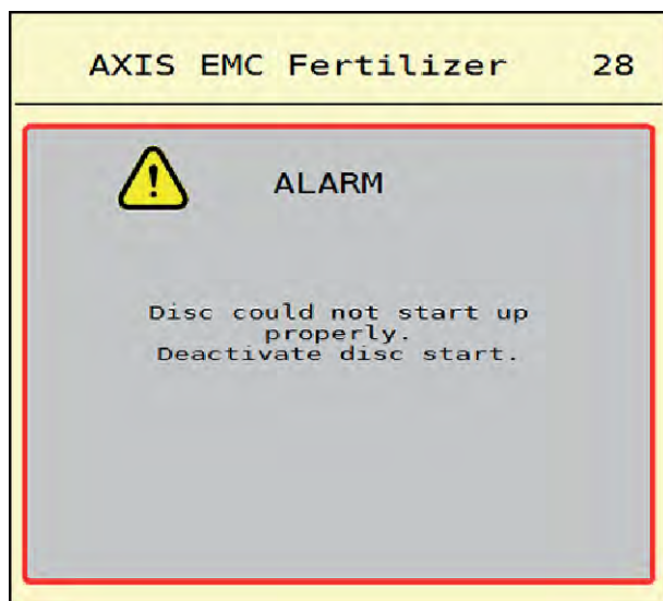
Fig. 50: Alarm message (example)
