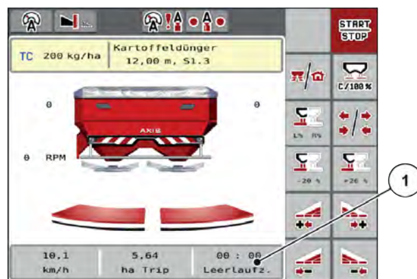
Abb. 49: Anzeige der Leerlaufmessung im Betriebsbild
