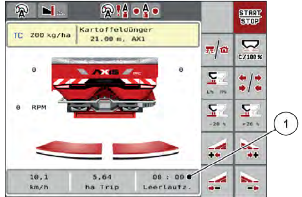
Şek. 31: Çalışma ekranında rölanti ölçümünün gösterimi
