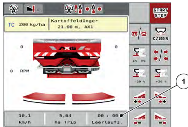
Obr. 31: Zobrazení měření vyprázdnění na provozní obrazovce
