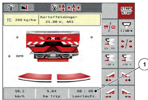
Sl. 31: Prikaz merenja u praznom hodu na radnom ekranu
