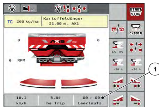
Rys. 31: Wskazanie pomiaru biegu jałowego na ekranie roboczym
