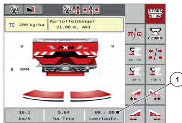
Rys. 31: Wskazanie pomiaru biegu jałowego na ekranie roboczym
