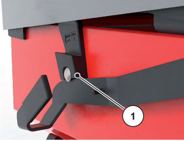
Şek. 49: Kapama brandası, kurutma pozisyonunda açık durumda kenetlenmiş
