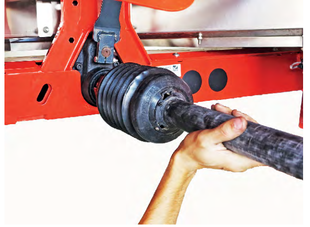
Şek. 17: Tahrik mili korumasının yerleştirilmesi
