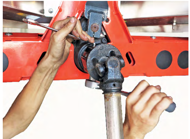
Фиг. 17: Закрепване на карданния вал
