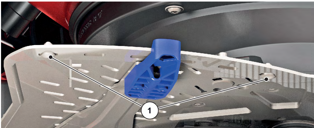
Фиг. 58: Закрепващи винтове на скалата
