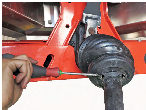
Фиг. 19: Фиксиране на защитата на карданния вал
