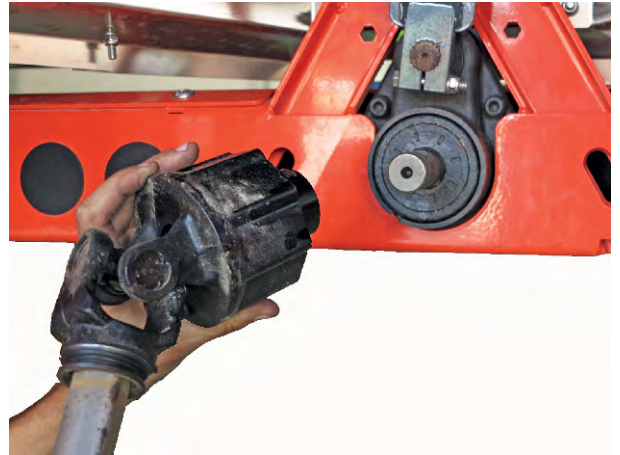
Фиг. 16: Поставяне на карданния вал върху края на вала на редуктора
