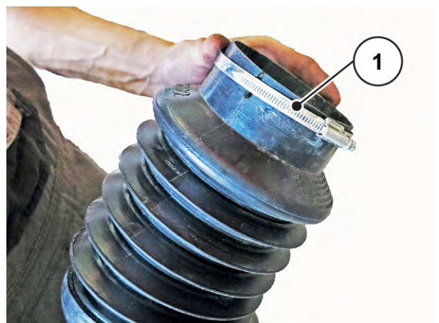
Фиг. 17: Закрепване на карданния вал
