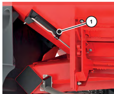
Фиг. 31: Позиция на регулиращия лост AXIS 25
