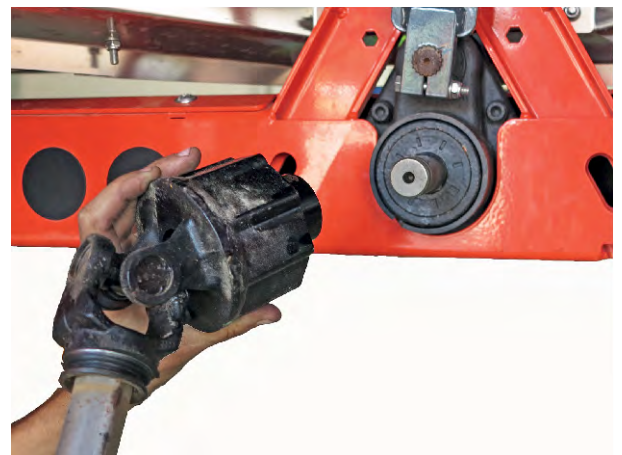
Pav. 16: Kardaninį veleną uždėjimas ant reduktoriaus kakliuko
