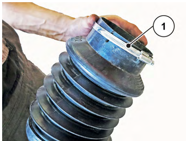
Pav. 17: Kardaninio veleno pritvirtinimas
