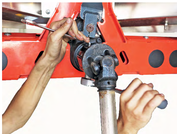
Pav. 17: Kardaninio veleno pritvirtinimas
