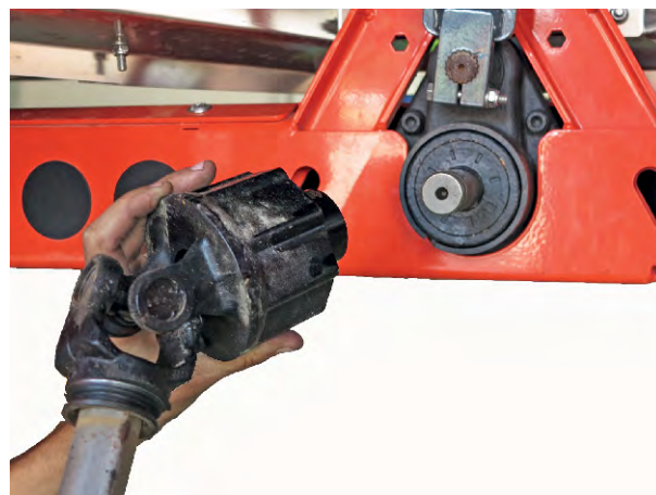
Ábr. 16: A kardántengely feltolása a hajtócsapra
