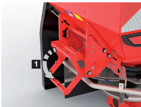
Fig. 27: Fotsteg med L-påbyggnad
