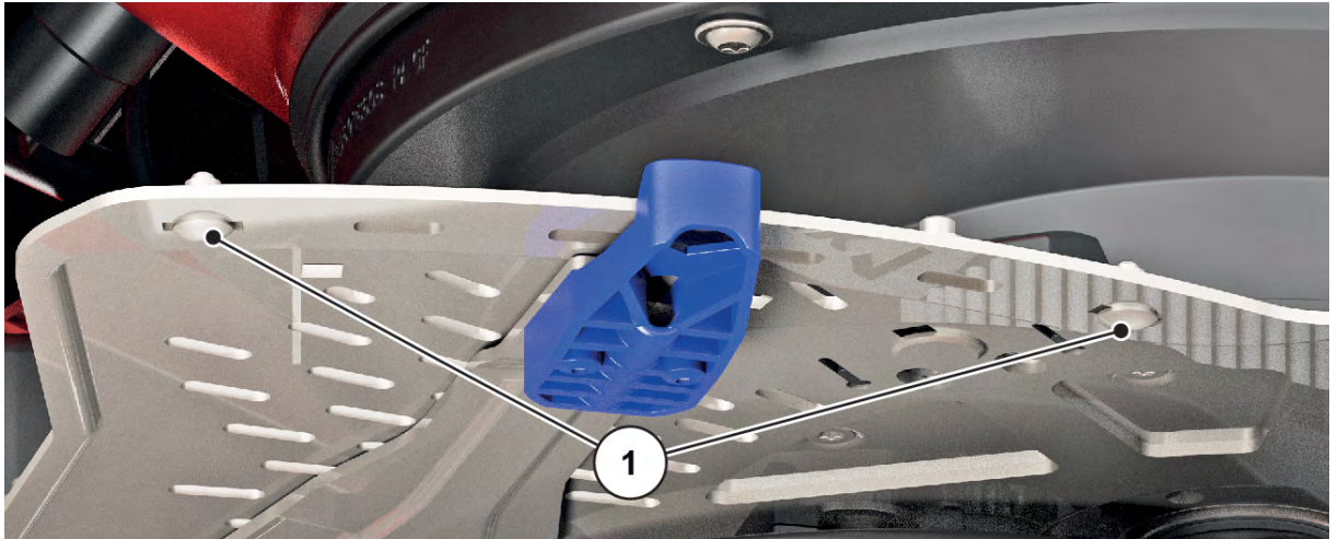
Afb. 58: Bevestigingsschroeven van de schaal
