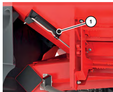
Afb. 31: Positie van de instelhendel AXIS 25
