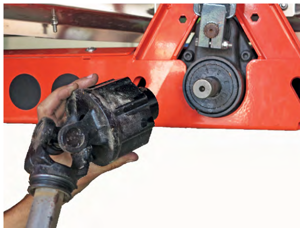
III. 16: Inserimento dell'albero cardanico sul perno del riduttore
