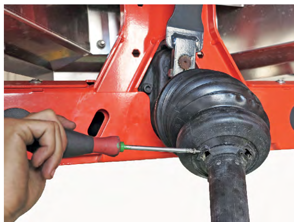
III. 19: Fissaggio della protezione dell'albero cardanico
