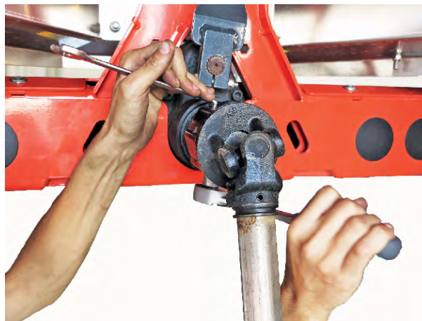
III. 17: Fissaggio dell'albero cardanico
