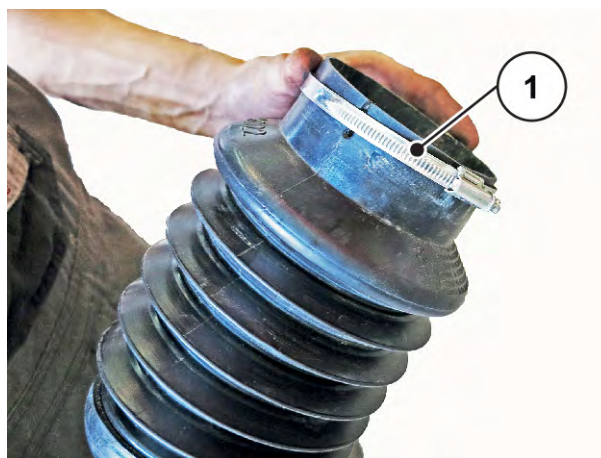
III. 17: Fissaggio dell'albero cardanico
