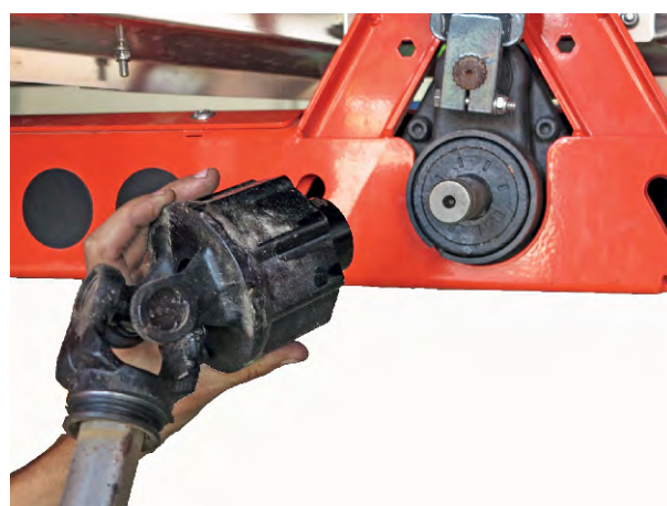
Sl. 16: Priključivanje kardanskog vratila na rukavac prijenosnika
