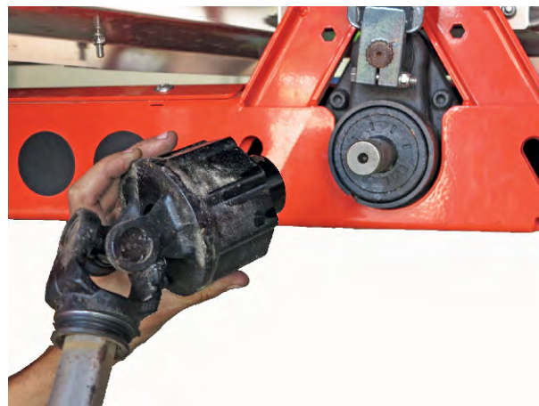
Σχ. 16: Πέρασμα αρθρωτού άξονα σε στροφέα κιβωτίου μετάδοσης
