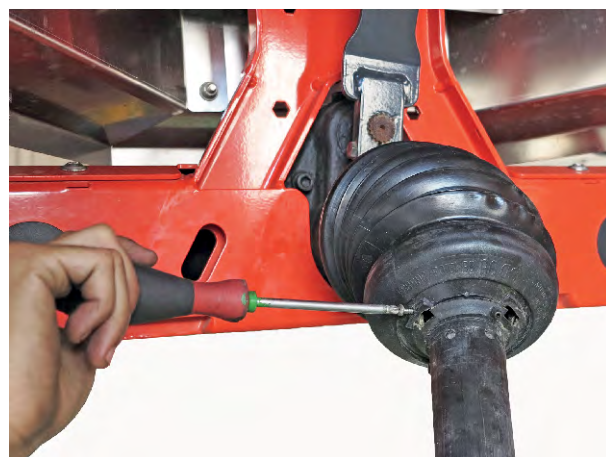
Fig. 19: Sikring af kardanakselbeskyttelsen
