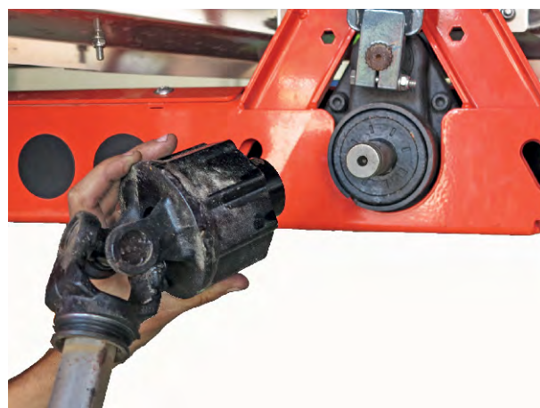
Fig. 16: Montering af kardanakslen på akseltappen
