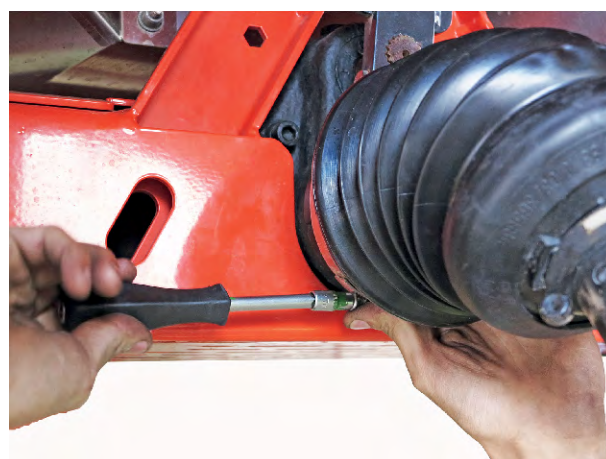
Fig. 20: Spænding af spændebåndet
