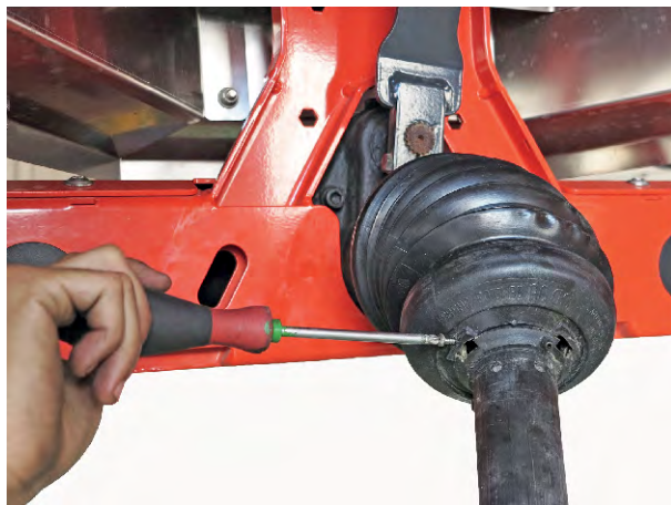
Obr. 19: Zajištění krytu kloubového hřídele
