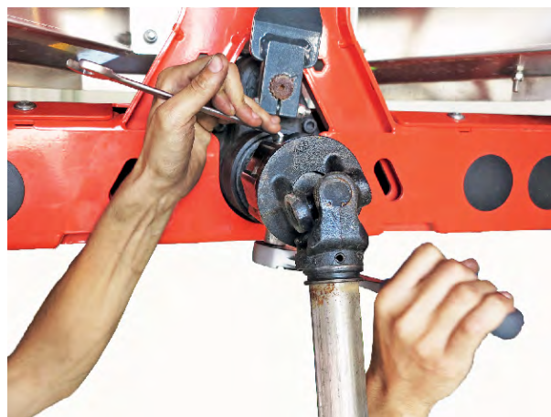
Fig. 17: Fixer l'arbre articulé
