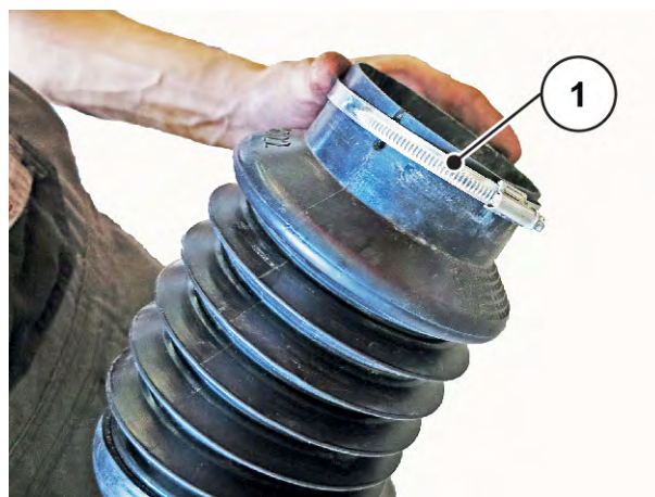
Fig. 17: Fixer l'arbre articulé
