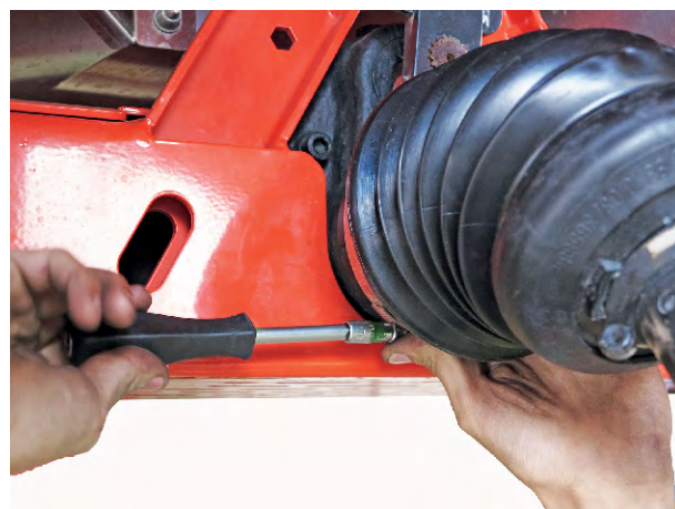
Fig. 20: Serrer le collier de serrage
