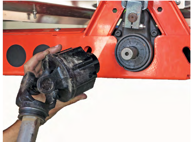
Abb. 16: Gelenkwelle auf Getriebezapfen aufstecken
