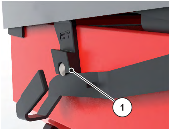
Abb. 50: Abdeckplane offen in Trocknungsposition eingerastet
