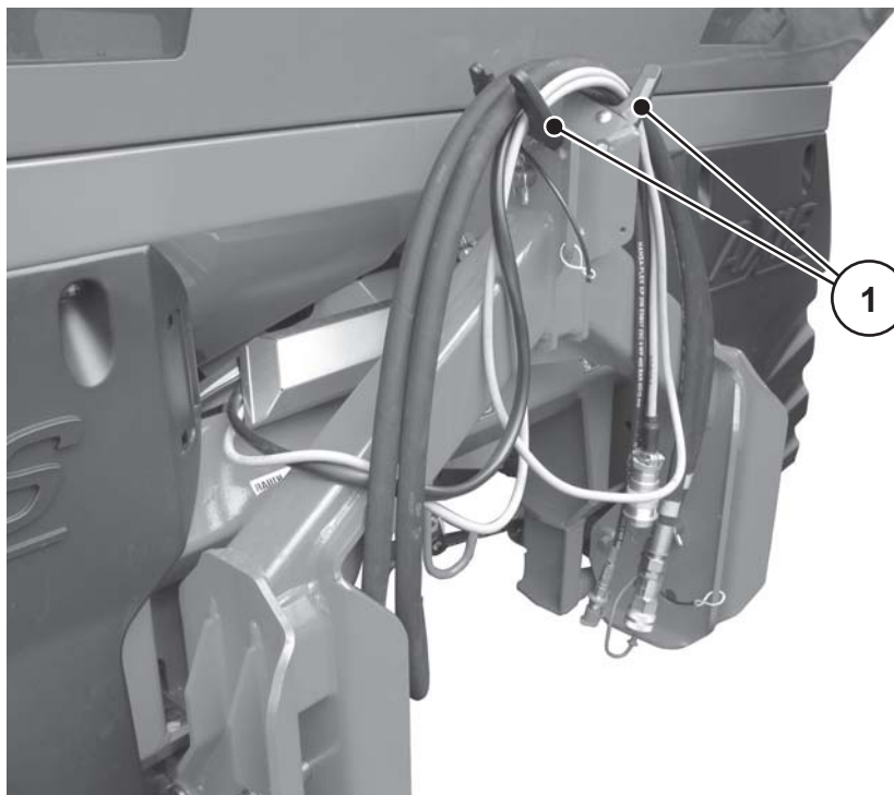
Imagen 8.10: Colocación de los cables y los latiguillos hidráulicos
