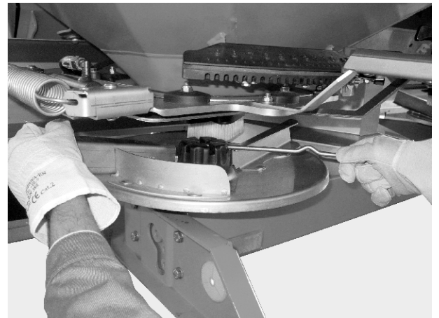
図 37: キャップナットをゆるめる
