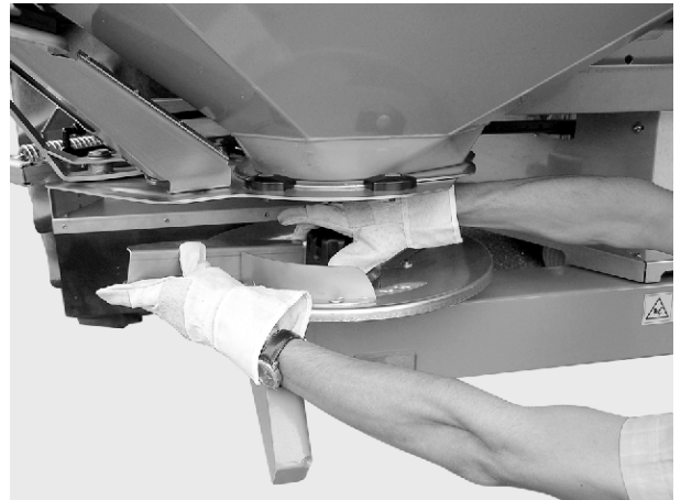
図 28: キャップナットを外す
