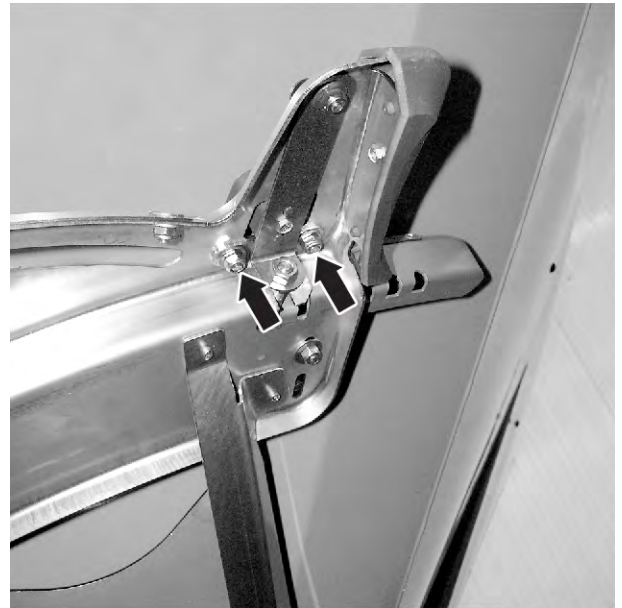
図 64: 放出ポイント調整プレートをゆるめる
