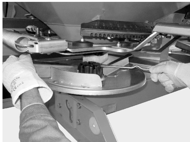
図 27: キャップナットをゆるめる
