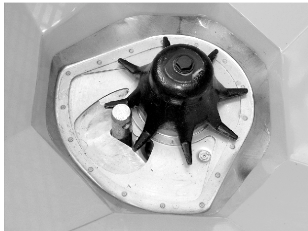
Att. 60: Apakšējās sviras tapa dozēšanas atverē
