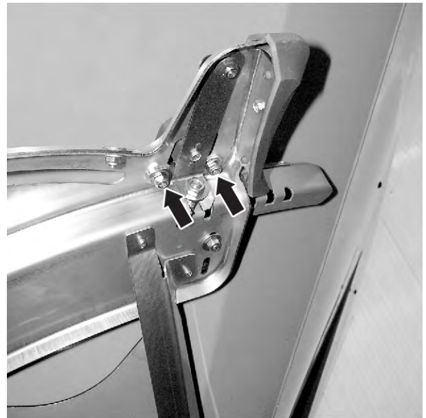
Att. 65: Padeves punkta regulēšanas plātnes atbrīvošana
