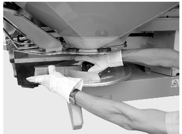
Att. 29: Kupoluzgriežņa noskrūvēšana
