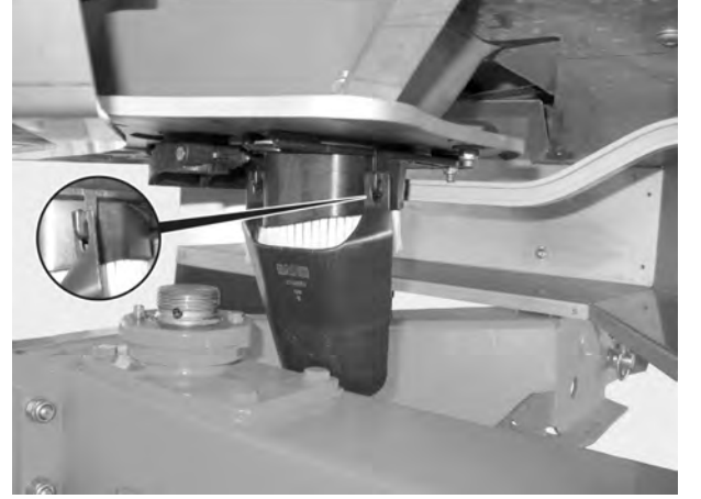
Şek. 38: Serpme testi oluğunun takılması
