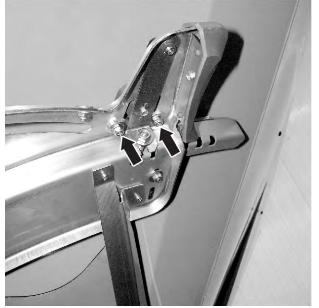
Şek. 64: Gübre verme noktası düzeltme levhasının sökülmesi
