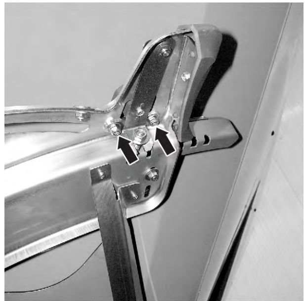
Obr. 64: Uvoľnenie nastavovacieho plechu bodu dávkovania
