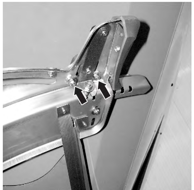
Pav. 64: Užduoties taško derinimo plokštelės atlaisvinimas
