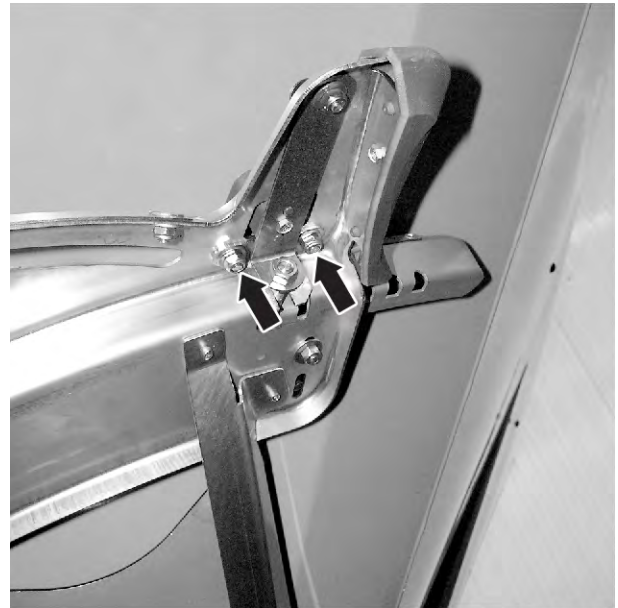
Sl. 65: Otpuštanje lima za fino podešavanje tačke za dodavanje materijala
