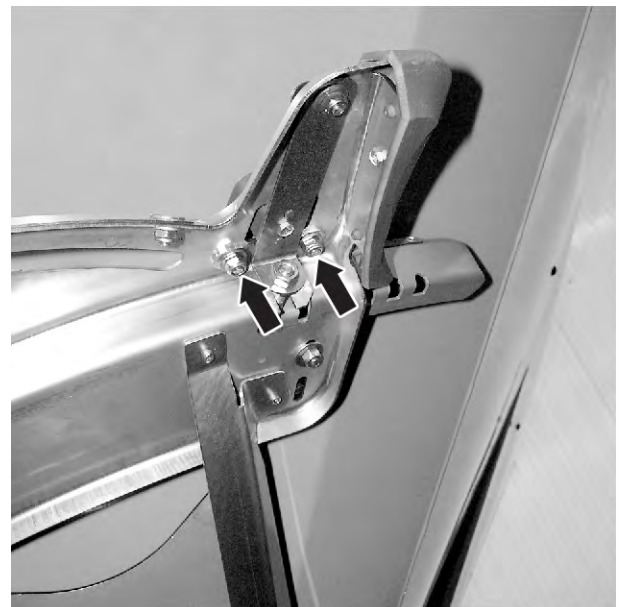
Ilust. 65: Soltar a chapa de ajuste do ponto de saída
