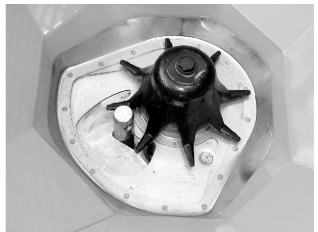
Ilust. 60: Pino do braço inferior na abertura de dosagem
