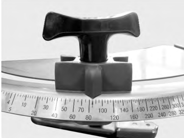
Ilust. 61: Ajuste da correção de dosagem da escala
