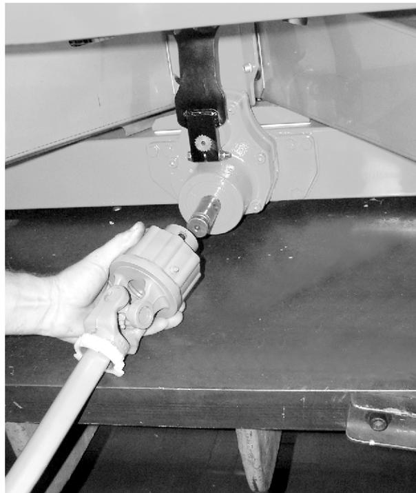
*Ilust. 11: Encaixar o eixo articulado no eixo da engrenagem*
