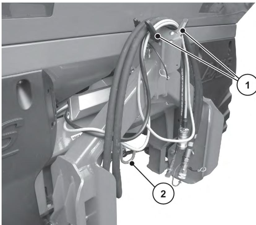
Ilust. 15: Deposição dos cabos e das mangueiras hidráulicas
