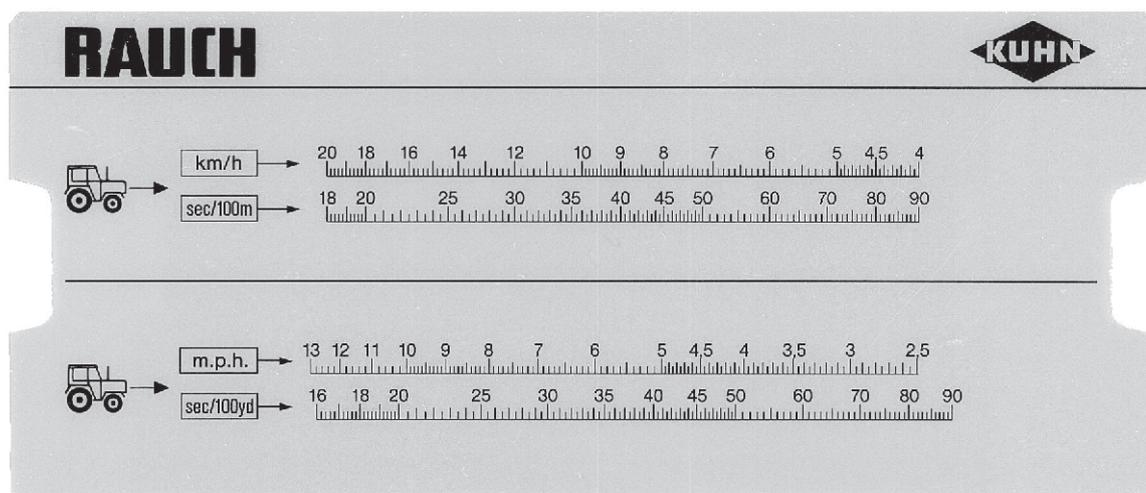
Ilust. 34: Escala para a determinação da velocidade de deslocação exata
