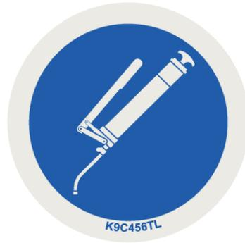
*Ilust. 65: Placa de indicação do ponto de lubrificação*
