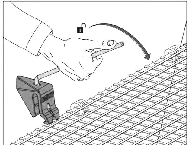
Ilust. 50: Abrir o bloqueio da grade de proteção
