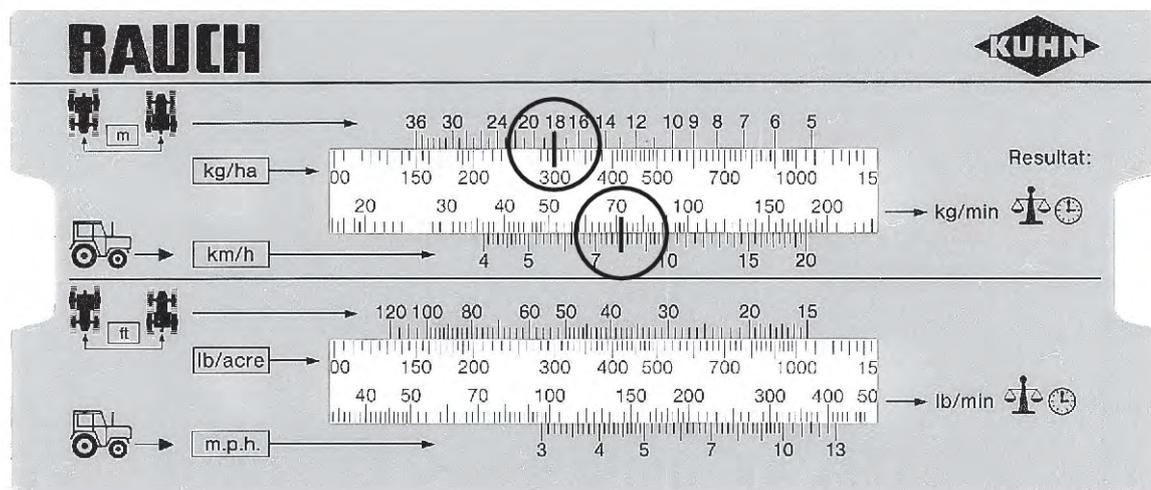
Ilust. 35: Escala para a determinação da quantidade nominal de saída por minuto
