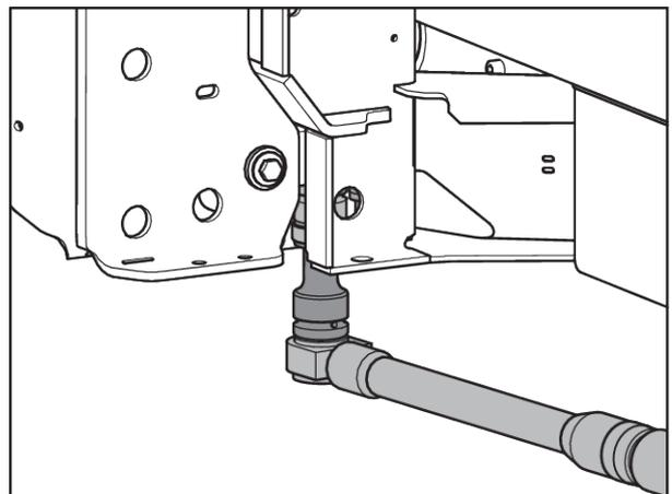
Ilust. 46: Fixação da célula de pesagem (em direção do trajeto à esquerda)
