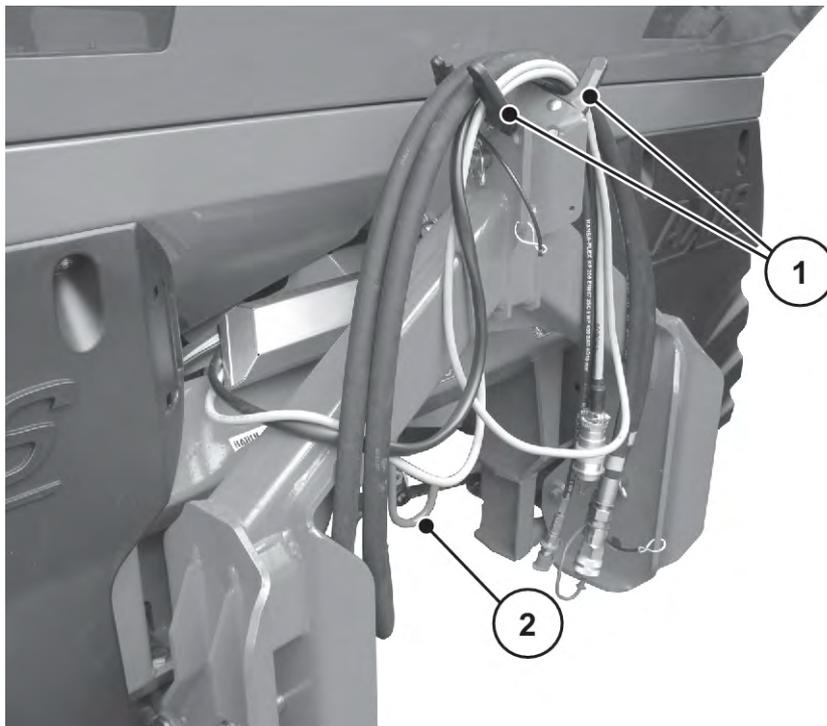
*Ilust. 41: Deposição dos cabos e das mangueiras hidráulicas*
