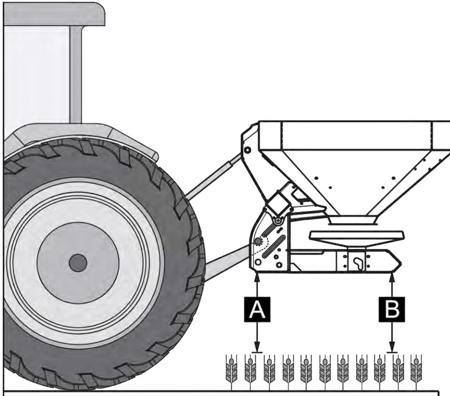
*Ilust. 19: Posição e altura de montagem na fertilização normal*
