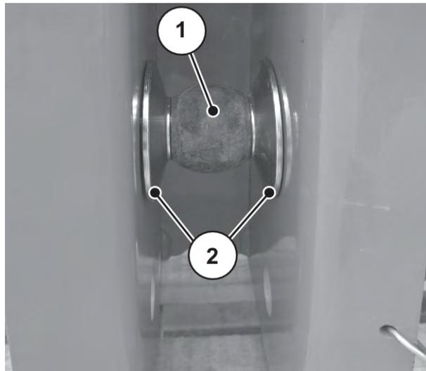
Ilust. 16: Posição das arruelas espaçadoras durante a montagem da máquina
