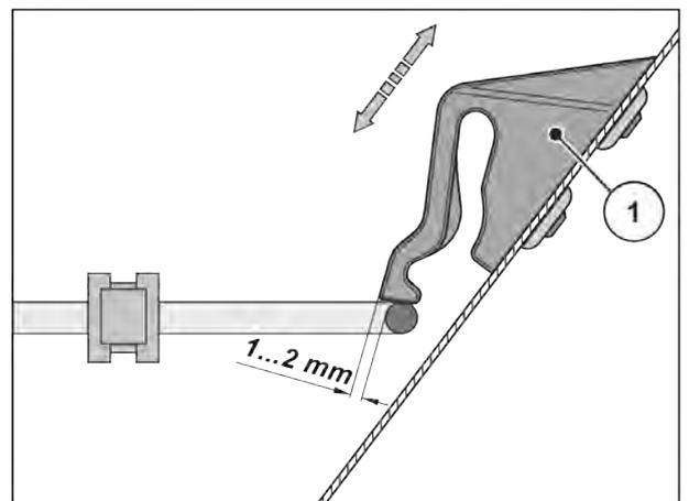
Ilust. 51: Medida de verificação relativa ao controlo de função do bloqueio da grade de proteção
