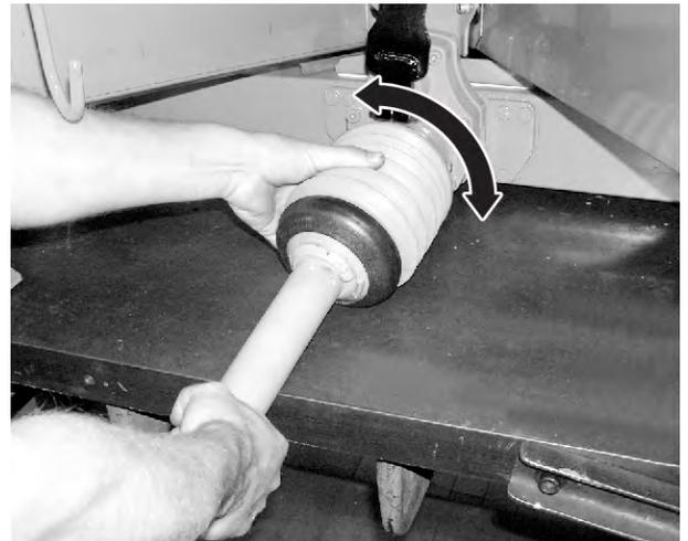
*Ilust. 13: Colocar a proteção do eixo articulado*
