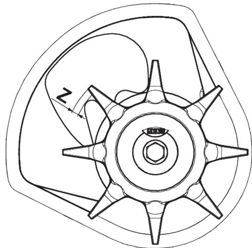
Ilust. 55: Área de desgaste da cabeça misturadora
