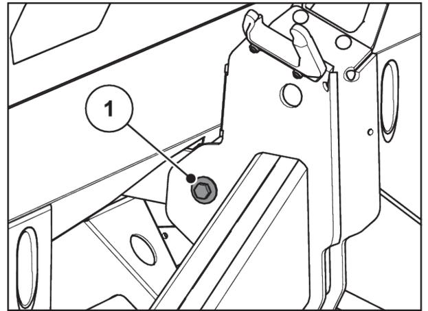
*Ilust. 47: Fixação da barra de tração na estrutura de pesagem*
