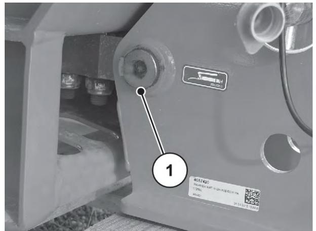
*Ilust. 66: Ponto de lubrificação do dispersor com células de pesagem*
