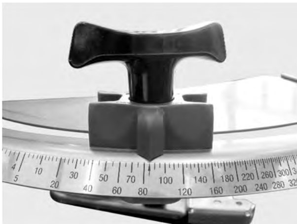
Рис. 61: Шкала для настройки заслонки дозатора
