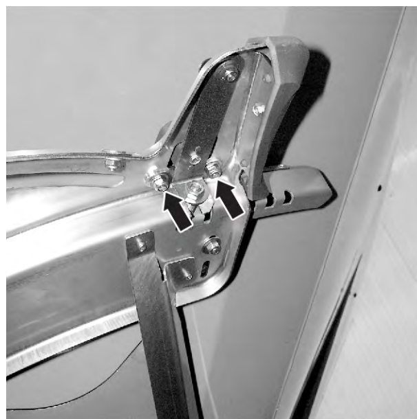
Рис. 65: Отсоединение юстировочной пластины точки подачи
