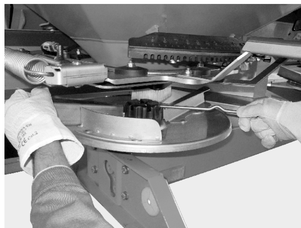
Рис. 37: Отвинчивание колпачковой гайки
