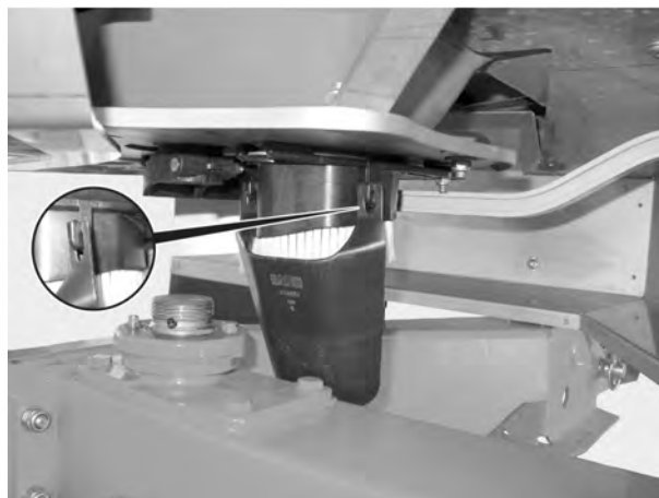
Obr. 39: Zavěšení žlabu na provedení zkoušky dávky
