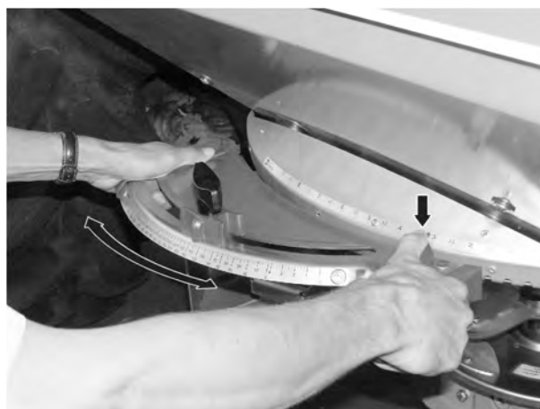
Sl. 29: Centar za namještanje točke za dodavanje materijala
