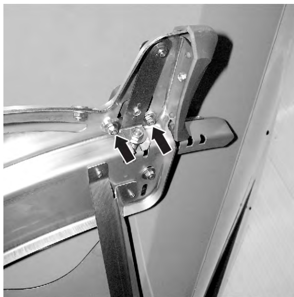
Sl. 64: Otpuštanje prilagodne ploče za točku unosa
