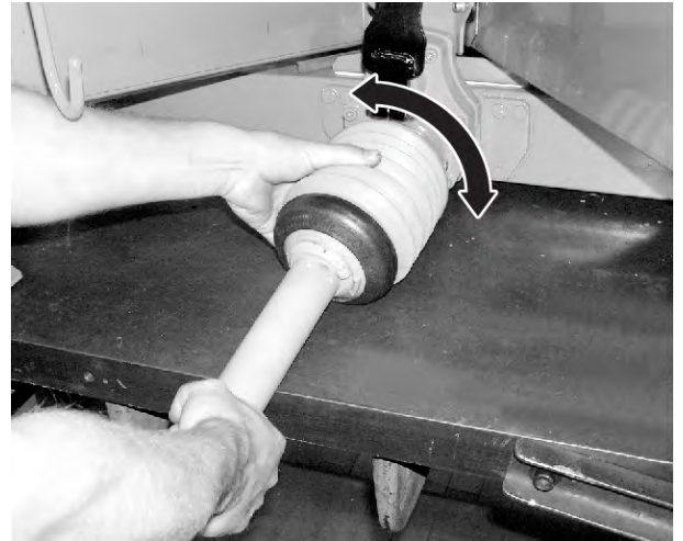
Fig. 13: Poziționare apărătoare arbore cardanic
