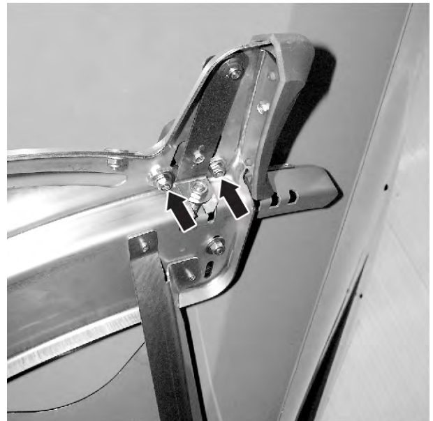
Fig. 64: Slăbirea plăcii de ajustare pentru punctul de alimentare
