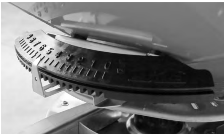
Fig. 30: Afișare pentru punctul de alimentare (exemplu)
