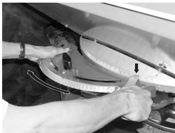
Mynd 29: Stillibúnaður fyrir útrennslisstað
