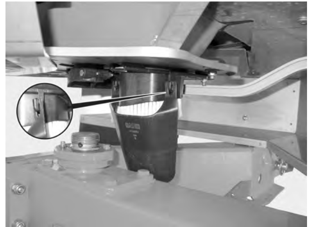
Σχ. 39: Ανάρτηση ολισθητήρα δοκιμής βαθμονόμησης
