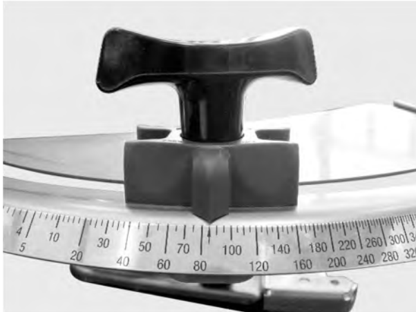
Σχ. 61: Κλίμακα ρύθμισης συρόμενου δοσομετρητή
