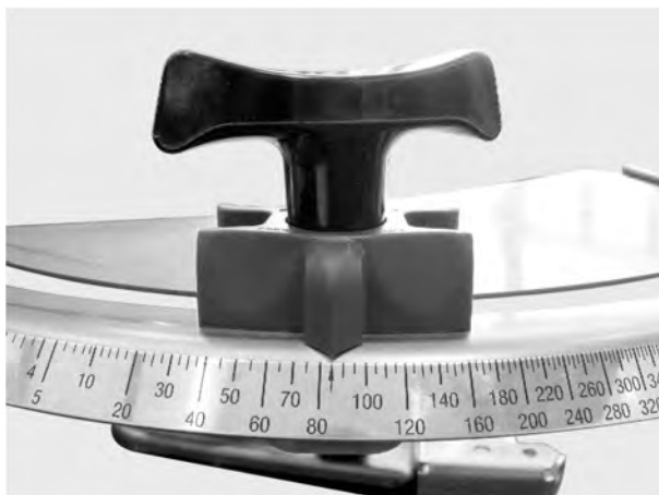
Фиг. 60: Скала за настройка на дозиращия шибър
