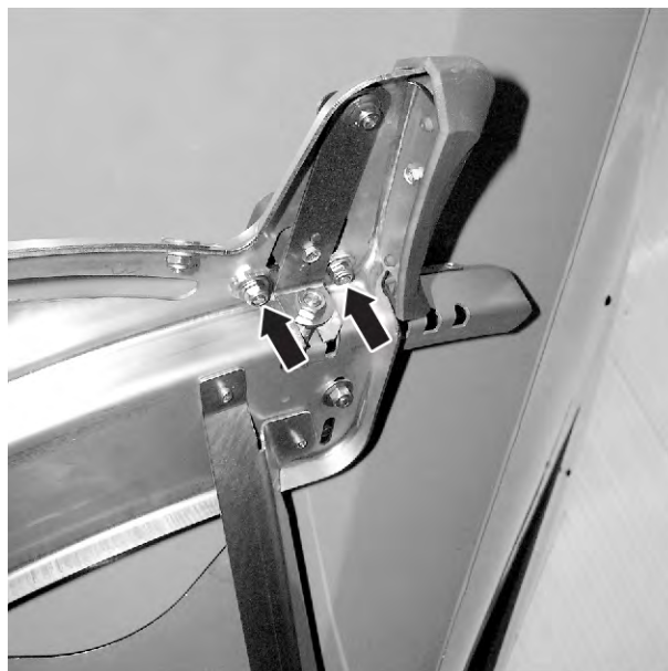
Фиг. 64: Освобождаване на регулиращата пластинка за точката на подаване
