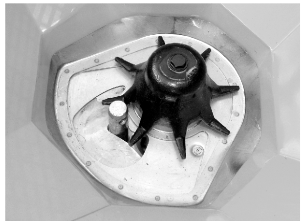
Rys. 60: Trzpień dolnego ramienia podnośnika w otworze dozującym
