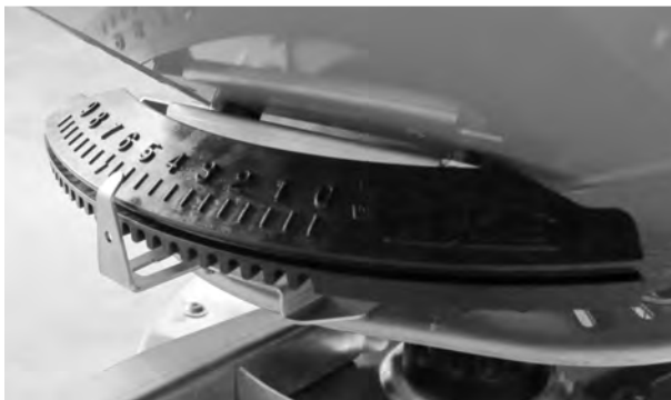
Rys. 30: Wskaźnik punktu podawania (przykład)
