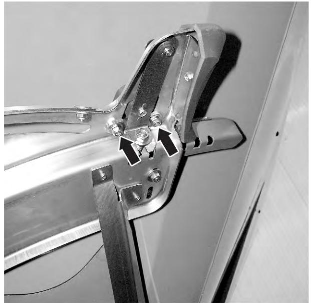
*Ill. 64: Staccare il pannello di taratura del punto di applicazione*
