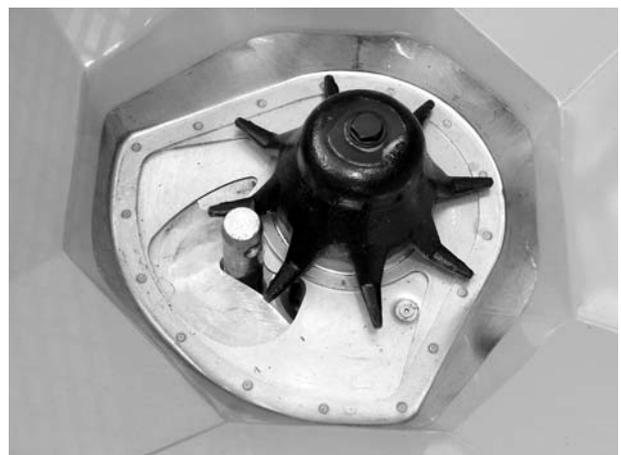
**Figure 10.18** : Axe de bras inférieur d'attelage dans la trappe
