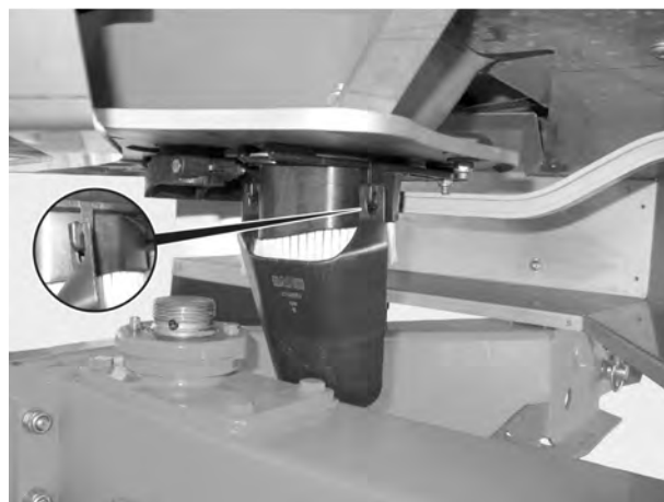
Рис. 43: Підвішування спускної труби для встановлення норми внесення добрива
