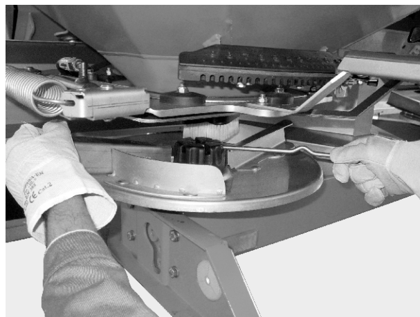
Рис. 32: Ослаблення ковпачкової гайки
