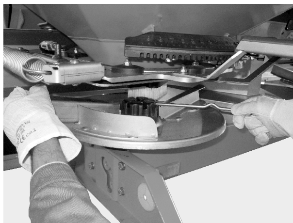
Рис. 42: Ослаблення ковпачкової гайки
