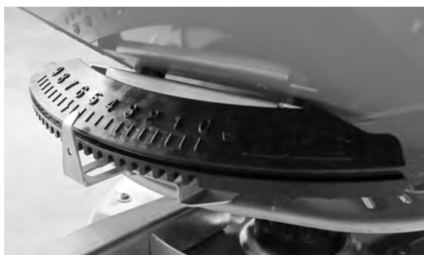
図 35: 放出ポイント調整の様子(例)
