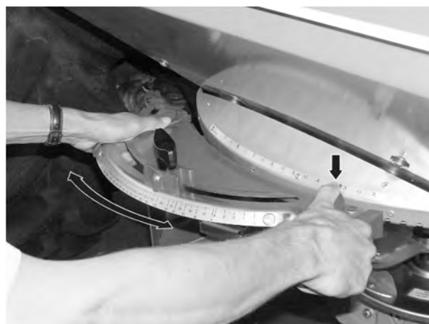
図 34: 肥料放出ポイント調整ユニット
