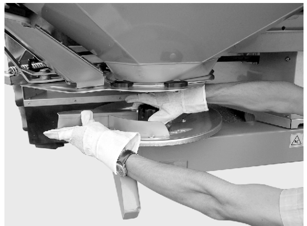
図 45: キャップナットを締め付ける
