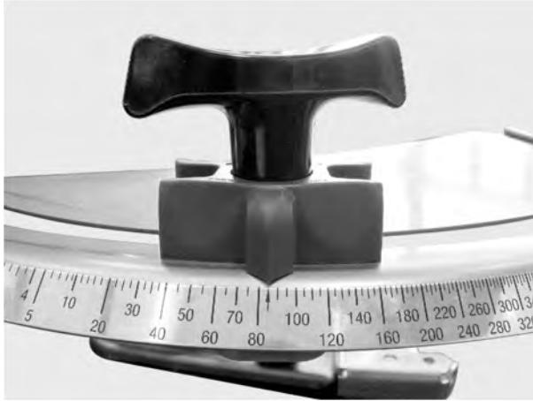
図 61: 計測スライドの設定スケール
