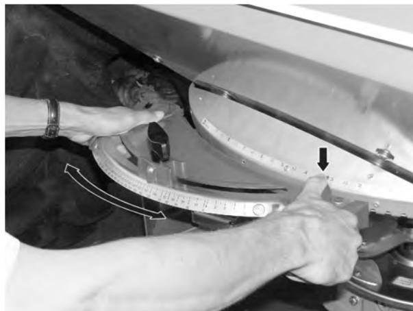
図 35: 肥料放出ポイント調整ユニット
