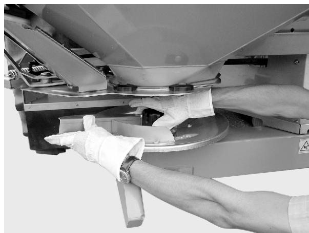
Att. 34: Kupoluzgriežņa noskrūvēšana
