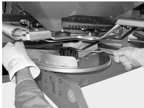
Att. 43: Kupoluzgriežņa atskrūvēšana
