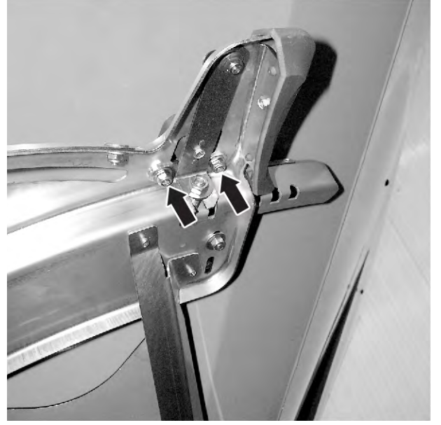
Şek. 65: Gübre verme noktası düzeltme levhasının sökülmesi
