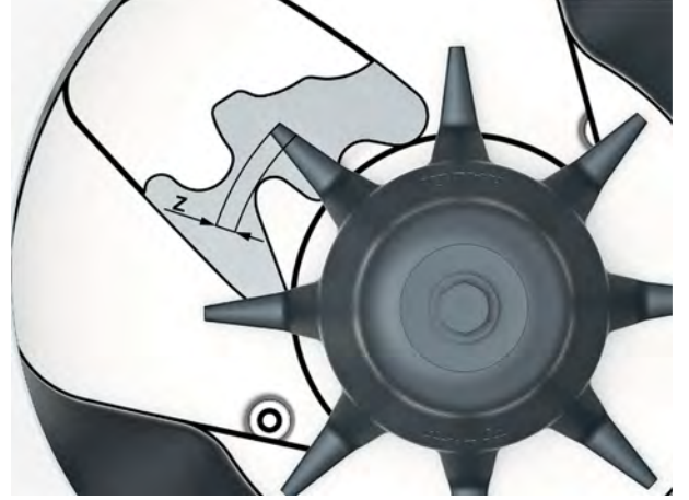
Şek. 56: Karıştırıcı kafasının aşınma bölgesi
