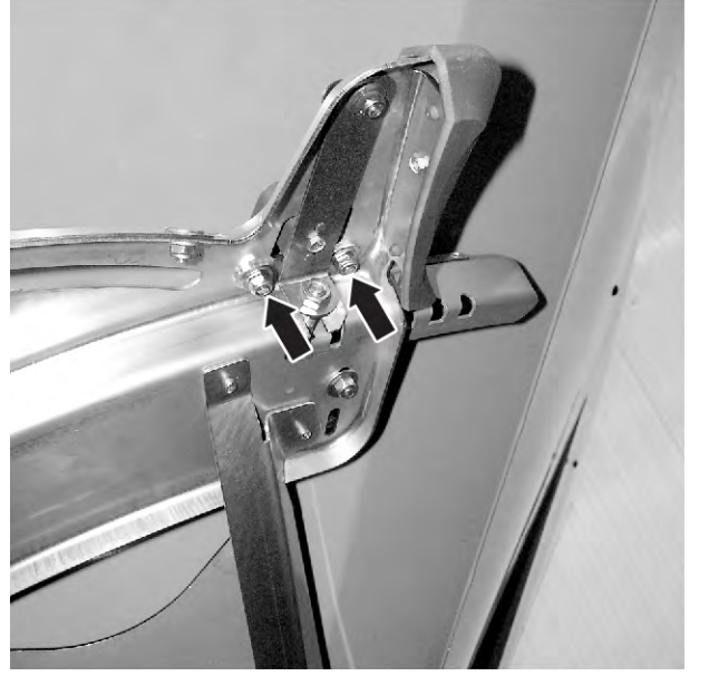
Şek. 70: Gübre verme noktası düzeltme levhasının sökülmesi
