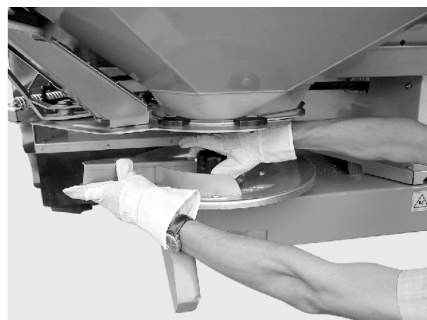
Sl. 34: Odvijanje klobučaste matice
