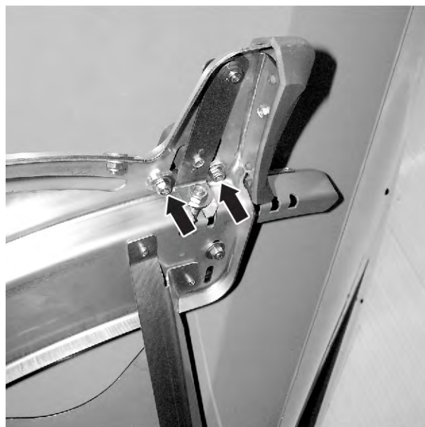
Sl. 66: Sprostitev nastavitvene pločevine točke dovajanja
