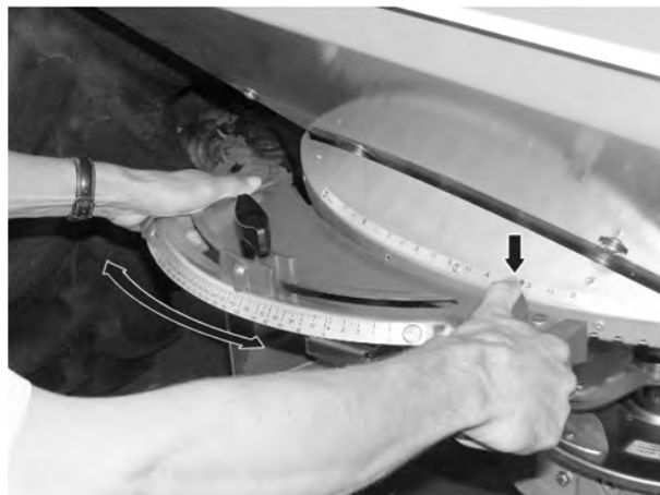
Sl. 35: Nastavitvena konzola za izstopno odprtino
